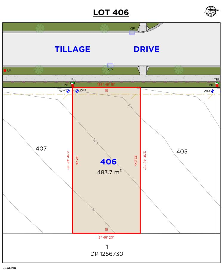
BOUNDARY LINE ADJACENT BOUNDARY SEWER GAS GAS LINE WM WATER METER
